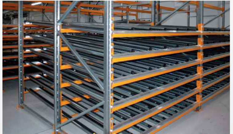
Das Durchlaufregal (FIFO) ermöglicht eine First-in-First-out-Lagerung.
