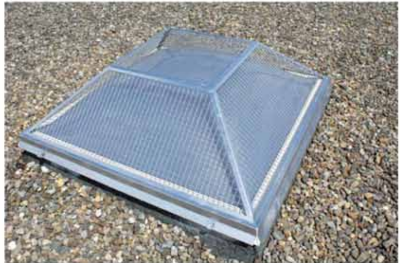
Rahmen aus Stahlblech, Füllung aus massivem Schweißgitter. Maschenweite 25 x 25 x 3 mm
