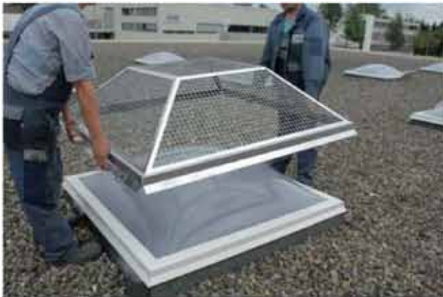
Rahmen aus Stahlblech, Füllung aus massivem Schweißgitter. Maschenweite 25 x 25 x 3 mm
