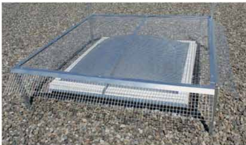
Schutzgitter für feststehende Lichtkuppeln mit 4-seitigem Prallschutz. Maschenweite 25 x 25 x 3 mm
